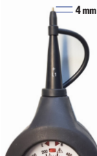
Schutzkappe kräftig aufstecken, dabei leicht drehen, bis die Spitze der Elektrode herausragt
